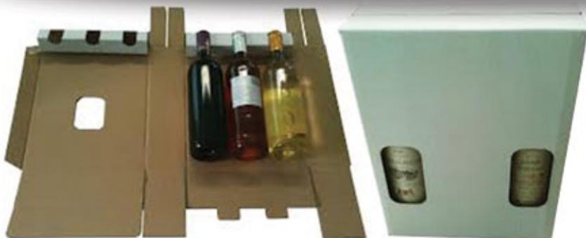
Ce type d'emballage pour bouteilles permet d'optimiser la protection des produits (les bouteilles ne sont pas en contact entre elles), de garder un visuel lorsque l'emballage est fermé, de n'être composé que d'un seul élément (calage intégré à l'emballage).
